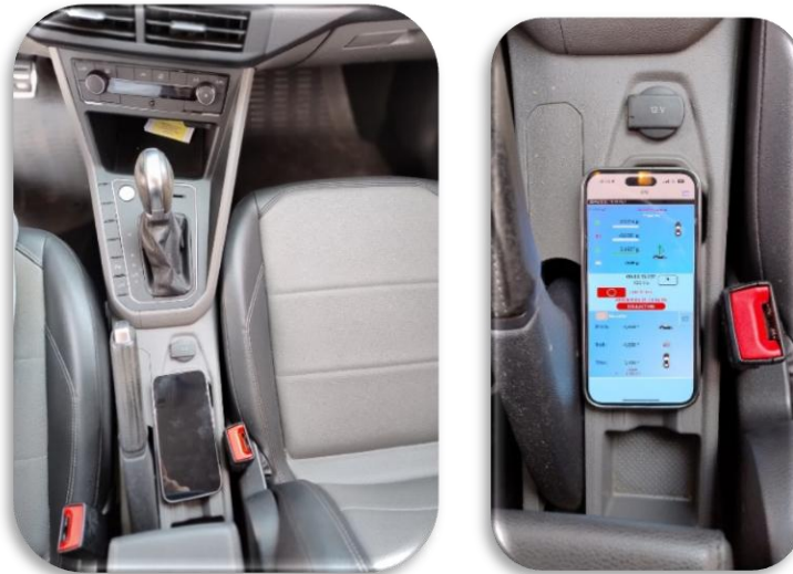
Ilustraciones 4 y 5: Ejemplo de fijación del teléfono móvil iPhone 14, equipado con el aplicación GFRecorder, al soporte original del vehículo, cerca del pomo de la palanca de cambio de marchas.
