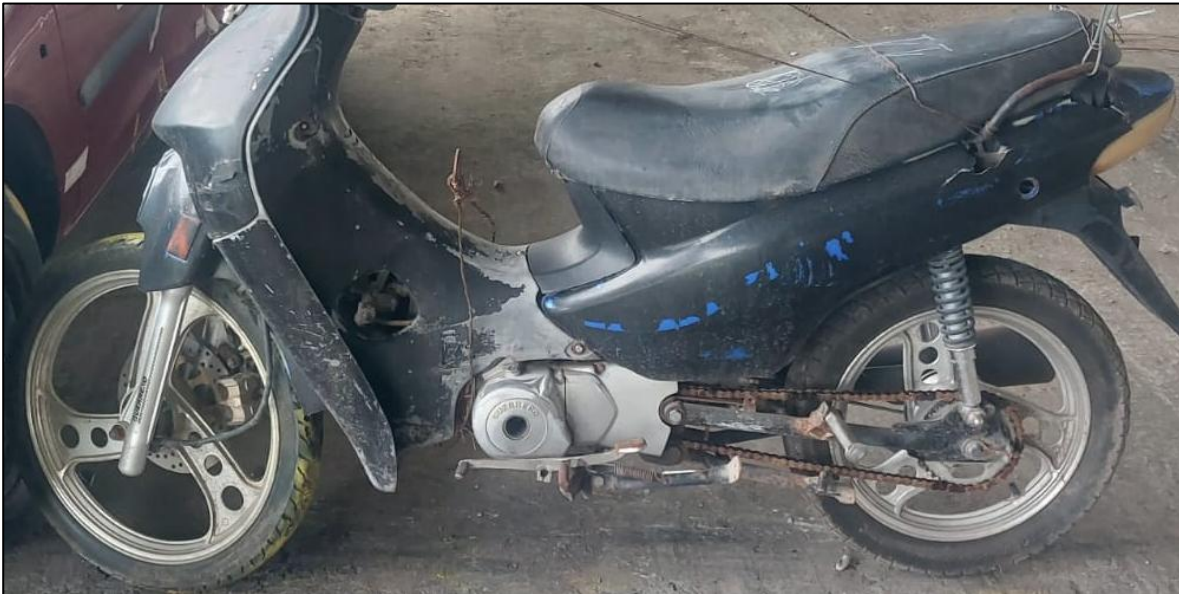
DAÑOS SOBRE LA MOTOCICLETA A 33 KM/H (RUEDAS ALEACION DE ALUMINIO)
