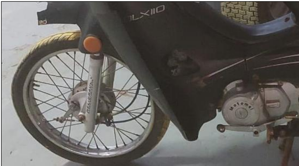
DAÑOS SOBRE LA MOTOCICLETA A 29 KM/H (RUEDAS CON RAYOS DE ALAMBRE)
