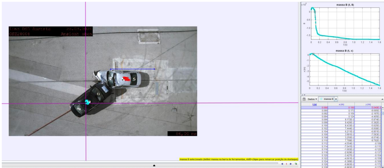
Ilustración 20: Validación de las gráficas obtenidas por medio del software libre Tracker para el vehículo negro.
