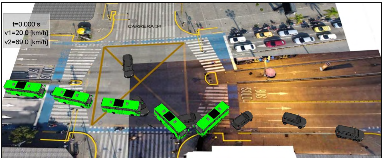
Figura N° 2: Resultado de la simulación por PC-Crash®. Resultados de velocidad en el recuadro superior rojo.
