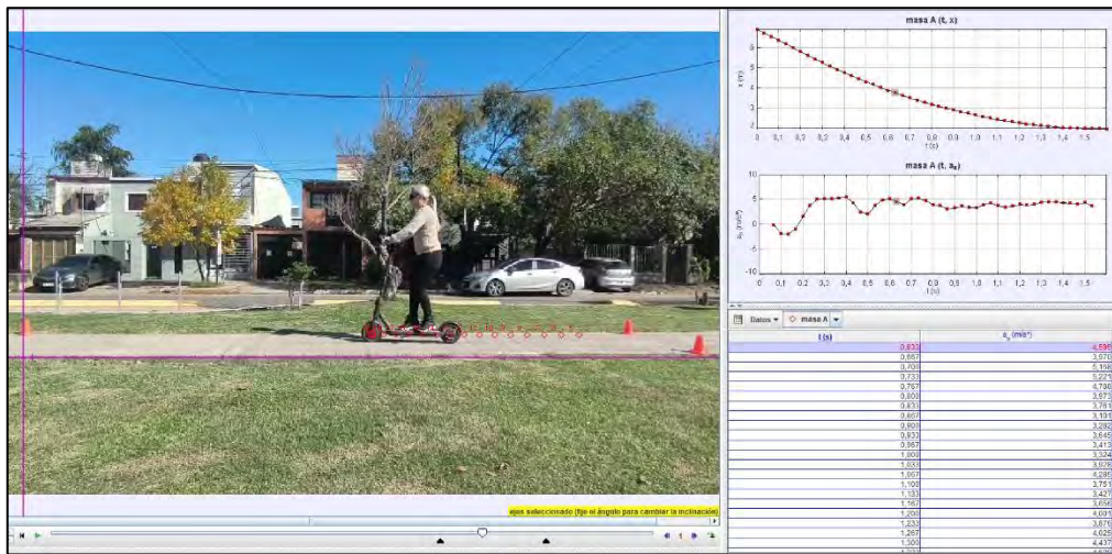
Figura 2: pantalla de trabajo de Tracker® y datos obtenidos de desaceleración media.
