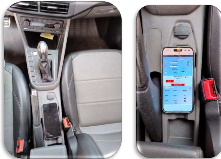
Ilustraciones 4 y 5: Ejemplo de fijación del teléfono móvil iPhone 14, equipado con el aplicación GFRecorder, al soporte original del vehículo, cerca del pomo de la palanca de cambio de marchas.
