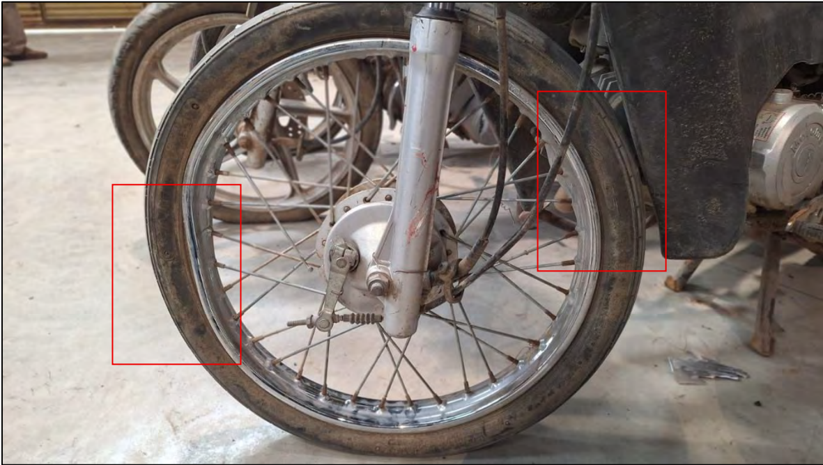
DAÑOS SOBRE LA MOTOCICLETA A 40 KM/H (RUEDAS CON RAYOS DE ALAMBRE)
