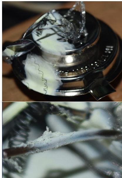
Figura N°5: Oxidación blanquecina presente en los filamentos y base de los focos rotos, estando encendidos.
