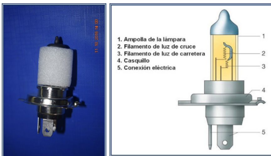
Figura N°1: Gráfico sobre las partes que componen una bombilla.
